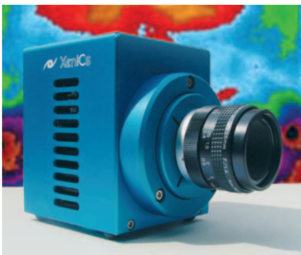
Bild 2: Digitale NIR-Kamera (0,85 bis 2,5 \mu\text{m} ) mit thermoelektrisch gekühltem Focal Plane Array (320 x 256 Bildpunkte)
