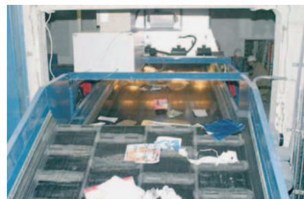
Bild 5: Wertstoff-Anlieferung, Vereinzelung und Klassifizierung durch NIR- und visuelle Technologien mit der SIS-Oberfläche des Spectrosort von Carinthian Tech Research (Bild CTR)
